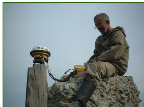
Рис. 3 Измерение координат опорной точки
