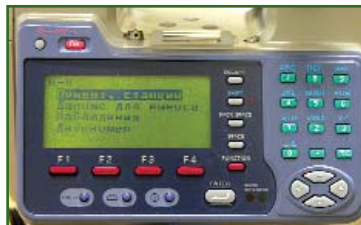
Рис. 2 Панель управления прибором серии SETx130R
